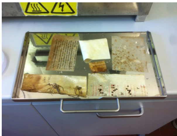
Figura 2. I campioni bagnati sono stati leggermente strizzati e lasciati a sgocciolare l'acqua in eccesso.
